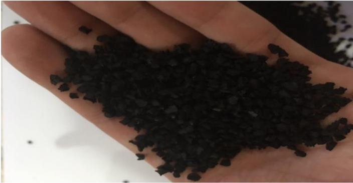
Figura 2 Resíduo de Borracha de pneu granulado 2,5 a 3,0mm
