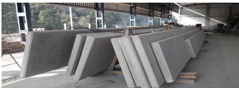
Figura 01 Painel de fechamento pré-fabricado composto de concreto convencional (sem resíduo de borracha).
