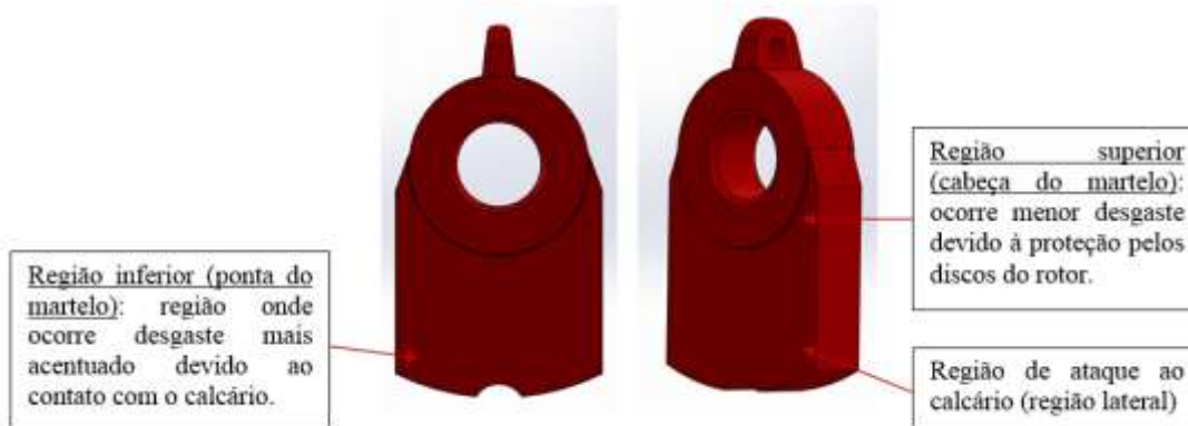
Figura 3: Martelo anteriormente utilizado no britador da Empresa “J”
